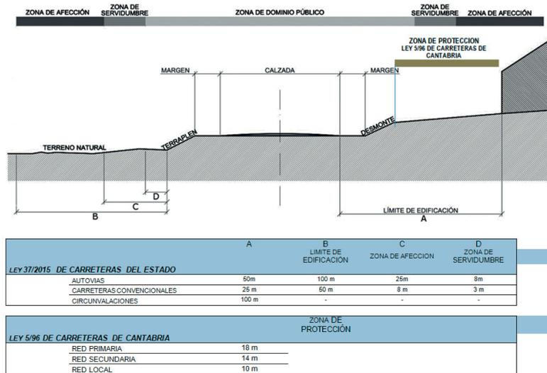
6 Esquema de afecciones según la legislación estatal de carreteras
