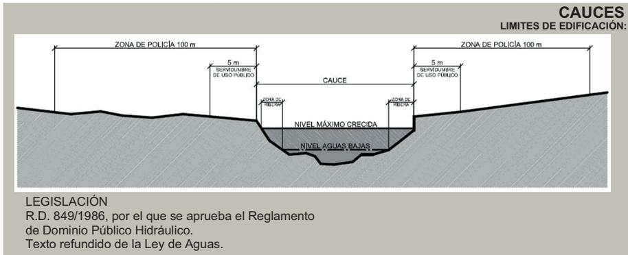
1 Esquema de afecciones según la legislación estatal de aguas
