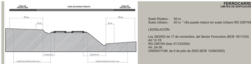
4 Esquema de afecciones según la legislación de ferrocarriles
