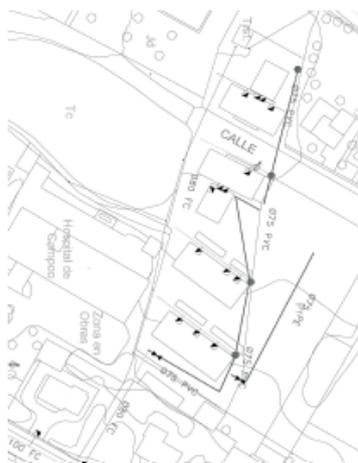
Por tanto, se procederá al desplazamiento de la arqueta de abastecimiento afectada, ubicándola en el lateral del nuevo volumen adosado, conectando la tubería de conexión interior, garantizando el correcto funcionamiento de la instalación, tras comprobar la disposición existente de los elementos. Se refleja gráficamente en el plano correspondiente.
