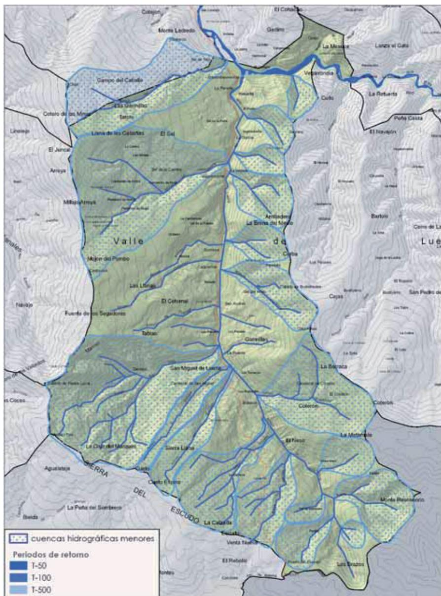
**Fig.8.** Esquema de la compartimentación en valles-afuentes de río Magdalena y de la red hidrográfica superficial, y zonas afectadas por riesgo de inundabilidad.
