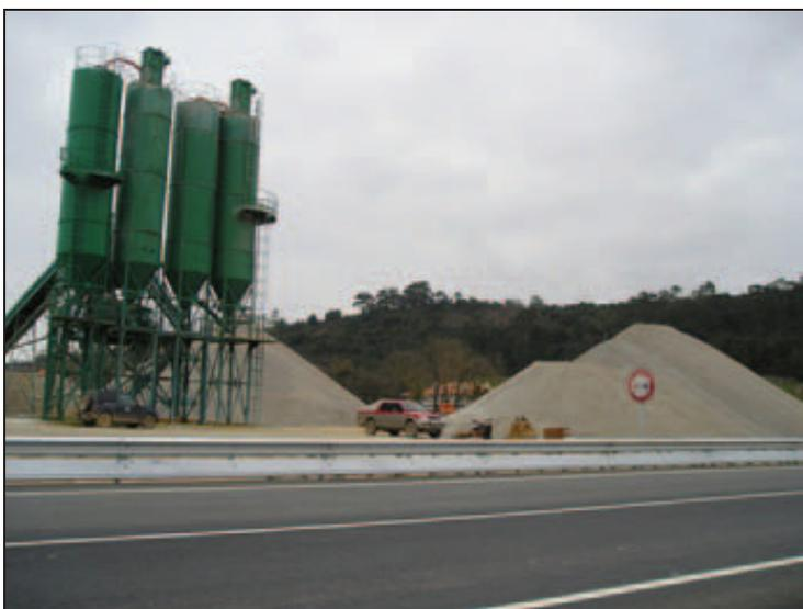
Figura F2 – Una cantidad importante de áridos se almacenan a la intemperie y son expuestas a resuspensión por acción del viento
