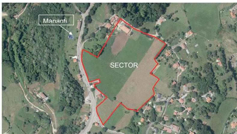
Dista 58 metros del manantial de Solía, el cual se encuentra situado en la margen derecha del arroyo de Obregón, discurriendo la carretera CA-142 entre ambos, que a su vez le permite contar con una buena comunicación por carretera. La conducción necesaria para el transporte del agua hasta el sector requiere la ejecución de una hinca bajo dicha carretera.
